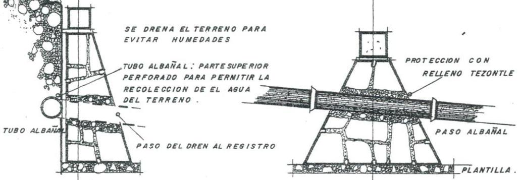
SEA CUAL FUESE EL TIPO DE TUBERIA PARA EL DRENAJE SE DEBERA TENER PREPARADO EL PASO DE ESTE ELEMENTO EN LA CIMENTACION, PARA PERMITIR ABSORBER LOS MOVIMIENTOS POSIBLES, Y EVITAR LA RUPTURA DE DICHAS INSTALACIONES
