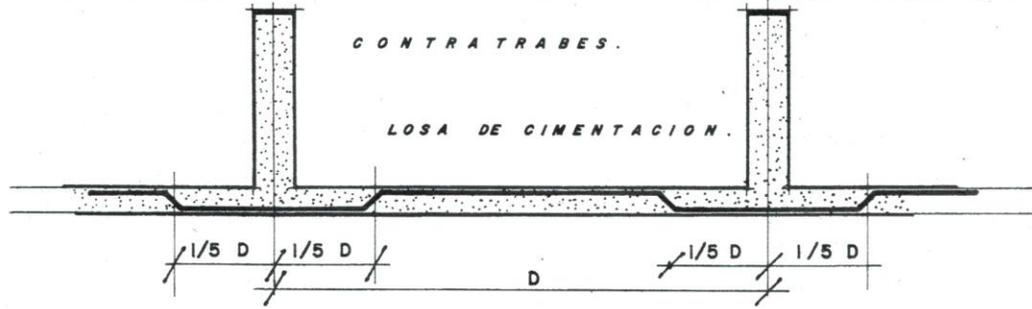
**CIMENTACION CON LOSA RIGIDA (O PLATAFORMA DE CIMENTACION)**
