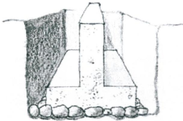
El concreto no debe contaminarse con el suelo ni el suelo debe absorber agua de la mezcla.
