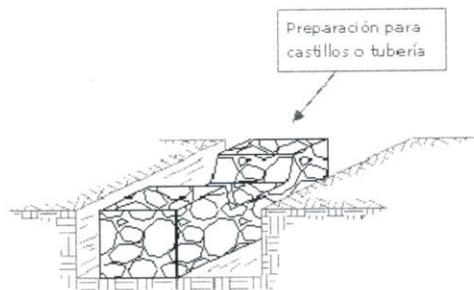
Encima de la cimentación se construye una solera o cadena de repartición (dala de desplante) cuya función principal es la de transmitir las cargas verticales y ayudar a la estructura a trabajar correctamente en casos de asentamientos.
