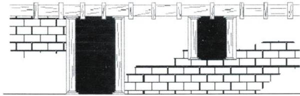
Las cadenas de remate se cuelan a media altura dejando sin concreto las varillas superiores para amarrar la losa.
