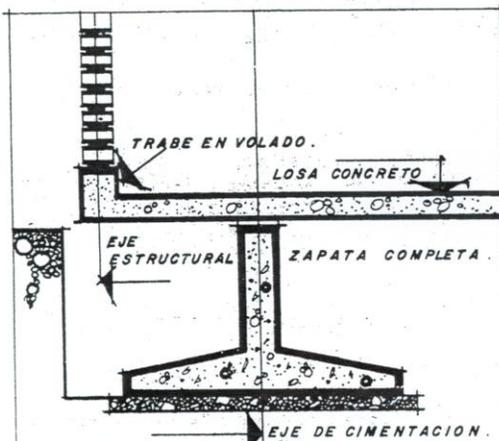
3.) SE REMETE EL EJE CONSTRUCTIVO DE CIMENTACION, PARA LOGRAR LA ZAPATA COMPLETA, LAS CARGAS LAS TOMA PRIMERO LA CONTRABE.
