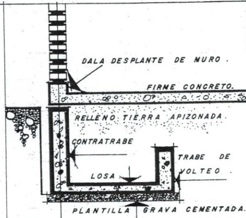
4.) SE SUPRIME LA ZAPATA COLINDANTE; SE UNE LA CONTRABE Y UNA TRABE DE VOLTEO, MEDIANTE UNA PEQUEÑA LOSA.
