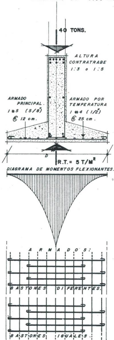
LA ZAPATA SE CALCULA A LA FLEXIÓN Y SE REVIZARA AL ESFUERZO CORTANTE, ( PARA TERRENOS MALOS HASTA DE 700 g/cm<sup>2</sup> SE USARAN ZAPATAS CORRIDAS.) (APROX. 7 TONS x M<sup>2</sup>)
