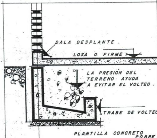
2.) EN ESTE CASO SE UTILIZA UNA TRABE DE VOLTEO INTEGRAL (COLADA EN LA MISMA ZAPATA).
