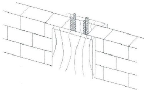
El armado de las cadenas de remate o cerramientos es exactamente igual que el de las dalas.
