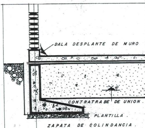
1.) MEDIANTE UNA CONTRABE PARA TENER UNA UNIÓN O LIGA, CON LA CIMENTACIÓN INTERIOR MÁS CERCANA, Y ASÍ EVITAR EL VOLTEO DE LA ZAPATA.
