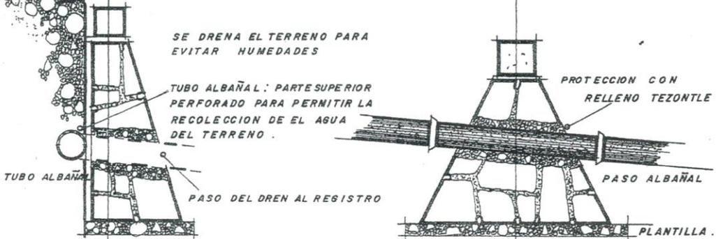
SEA CUAL FUESE EL TIPO DE TUBERIA PARA EL DRENAJE SE DEBERA TENER PREPARADO EL PASO DE ESTE ELEMENTO EN LA CIMENTACION, PARA PERMITIR ABSORBER LOS MOVIMIENTOS POSIBLES, Y EVITAR LA RUPTURA DE DICHAS INSTALACIONES
